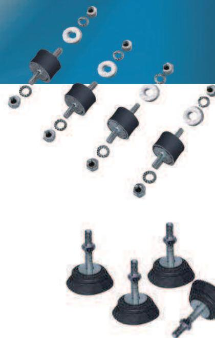
AVP / AVT - SUPPORTI ANTIVIBRANTI in gomma nera e naturale che se applicati tra l'unità esterna e il supporto di sostegno consentono, oltre che a fissare la macchina stessa, ad eliminare qualsiasi vibrazione. Due le tipologie disponibili: passanti e da terra. Sono forniti in KIT di 4 antivibranti con relative rondelle e dadi.
