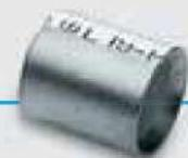
I giunti della serie L-P sono ricavati da tubo di rame elettrolitico delle stesse dimensioni di quello usato per i capicorda della serie A-M; sono ricotti e protetti superficialmente mediante stagnatura elettrolitica. Sono dotati di smusso ad entrambe le estremità per una facile introduzione del conduttore.
