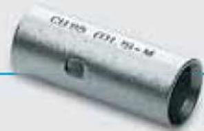
I connettori della serie L-M sono studiati per la giunzione di cavi di bassa tensione. Sono ricavati da tubo di rame elettrolitico delle stesse dimensioni di quello usato per i capicorda della serie A-M; sono ricotti e protetti superficialmente mediante stagnatura elettrolitica. Sono dotati di smusso ad entrambe le estremità e di uno "stop" nella zona centrale per una facile e corretta introduzione del conduttore.
