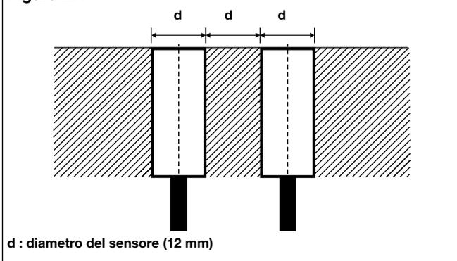
Sensore di prossimità a montaggio parzialmente schermato, quando installati insieme in materiale schermante, deve essere conforme alla figura 2B.
