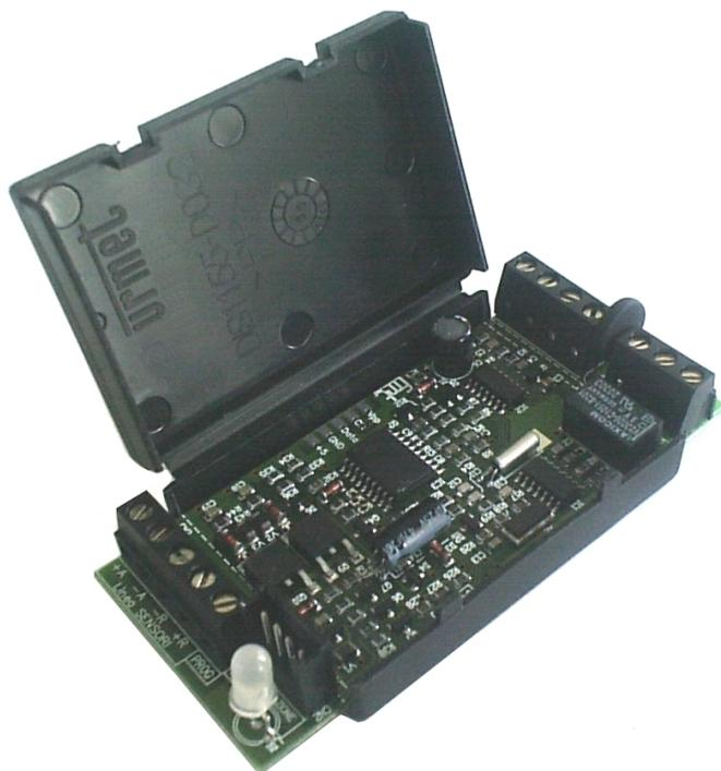
La scheda di interfaccia seriale **1043/277** consente il collegamento di rivelatori o contatti convenzionali non analogici (pulsanti, rivelatori di fumo, rivelatori di temperatura, rivelatori lineari di fumo 1043/010) od impulsivi, su impianti antincendio basati su centrale analogica a microprocessore 1043/260. Il dispositivo è provvisto di relè che, opportunamente programmato può comandare lampade ottico-acustiche, sirene, fermi elettromagnetici.
