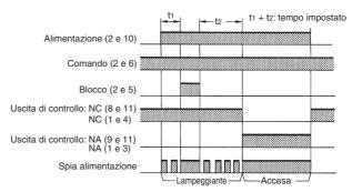
Segnale di blocco (il funzionamento viene interrotto con un segnale di blocco se il temporizzatore rileva un segnale anomalo).
