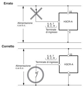
Non collegare relè o altri carichi tra i terminali di ingresso, poiché in caso contrario il circuito interno del temporizzatore si danneggia a causa della tensione elevata applicata a questi ultimi.
