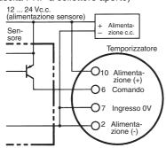
Funziona con transistor PNP ON
