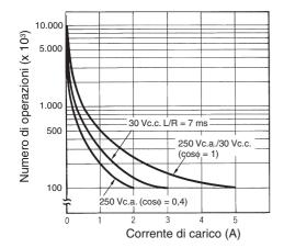
Condizioni:  $0.15 \text{ A} = \text{corrente commutabile a } 125 \text{ Vc.c.} (\cos \phi = 1). 0.1 \text{ A} = \text{massimo corrente commutabile con L/R} = 7 \text{ ms. In entrambi i casi}$ la vita del temporizzatore si aggira intorno alle 100.000 operazioni. Il carico minimo applicabile è 10 mA (100 mA per l'H3CR-A8E) a 5 Vc.c. (livello errori: P).
