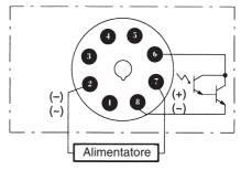
**Nota:** i terminali 1, 3, 4 e 5 non sono collegati. I terminali 2 e 7 sono utilizzati come nell'H3CR-A8.
