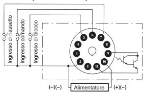
Nota: I terminali 1, 3, 4 e 8 non sono collegati. I terminali 2, 5, 6, 7 e 10 sono identici a quelli del modello H3CR-A.
