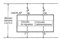
Poiché i circuiti di ingresso e di alimentazione sono configurati in modo indipendente, il circuito di ingresso può essere attivato o disattivato indipendentemente dallo stato di accensione o spegnimento del circuito di alimentazione.
