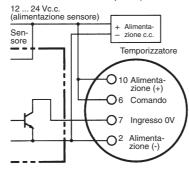
Funziona con transistor NPN ON
