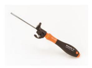
Utensile combinato per il taglio e l'avvitamento Swifty® e Swifty®set per il taglio senza deformazione di conduttori in rame rigidi fino a 1,5 mm² e flessibili fino a 2,5 mm².
