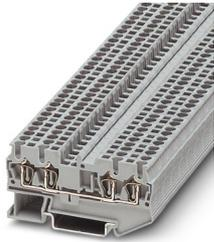
Morsetto passante, tensione nominale: 800 V, corrente nominale: 24 A, collegamento: Connessione a molla, Sezione di dimensionamento: 2,5 mm<sup>2</sup>, sezione: 0,08 mm<sup>2</sup> - 4 mm<sup>2</sup>, tipo di montaggio: NS 35/7,5, NS 35/15, colore: grigio
