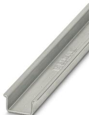
Guida di supporto, non perforata, a norma EN 60715, materiale: Acciaio, zincato, passivato a strato spesso, Profilo standard 2,3 mm, colore: color argento, Variante di imballaggio con 10 pezzi (20 m)
