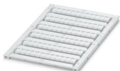
Segnamorsetti, Scheda, bianco, in bianco, siglabile con: TOPMARK NEO, TOPMARK LASER, BLUEMARK ID COLOR, BLUEMARK ID, BLUEMARK CLED, THERMOMARK PRIME, THERMOMARK CARD 2.0, THERMOMARK CARD, tipo di montaggio: fissare, per morsetti con spessore: 5,2 mm, dimensioni campo di siglatura: 4,4 x 4,7 mm, Numero dei cartellini singoli: 72
