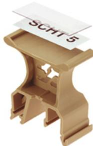
I portacartellini di gruppo **SchT 5 S** vengono montati direttamente sulle guide di supporto TS 32 (guida G) e TS 35 (guida a omega). Così l'identificazione della morsettiera è possibile indipendentemente dal punto di serraggio e dal tipo di morsetto.
