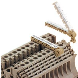
I portacartellini di gruppo SchT 5 / SchT 5 S vengono montati direttamente sulle guide di supporto TS 32 (guida G) e TS 35 (guida a omega). Così l'identificazione della morsettiera è possibile indipendentemente dal punto di serraggio e dal tipo di morsetto.
