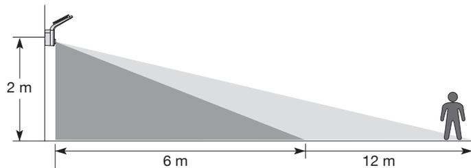
■ Zona de detección por defecto (a la salida de fábrica)
