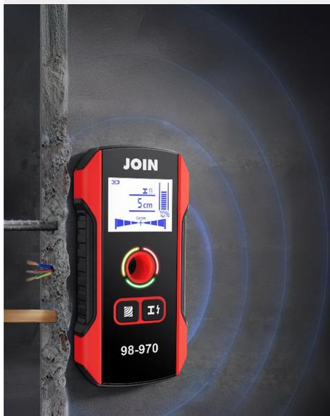
Questo strumento è progettato per individuare metalli (ferromagnetici e non ferromagnetici) come barre d'acciaio, tubi di rame e cavi elettrici sotto tensione all'interno di pareti, soffitti e pavimenti. È in grado di rilevare anche oggetti non metallici quali travi in legno, tubi pieni d'acqua e tubi di plastica, sotto rivestimenti in cartongesso, compensato e legno grezzo.
