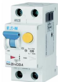
Interruttore magnetotermico differenziale, 20 A, 300 mA, caratteristica di intervento interruttore magnetotermico: C, 1p+N, caratteristica di sgancio differenziale: A
