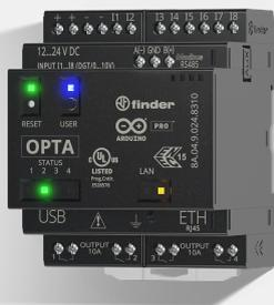
**Descrizione tecnica:** Opta - Programmable Logic Relay, PLR, 4 uscite, 10 A, Tipo di alimentazione DC, tensione di alimentazione nominale 24 V, funzionamento da 10.2 a 27.6 V, Numero di ingressi: 8 ingressi digitali/analogici, Contatti NO (SPST) - EMR, Versione Advances, porta Modbus RS485, RJ45, USB (porta di tipo C) e modulo integrato WiFi/BLE, temperatura ambiente da -20 a +55 °C
