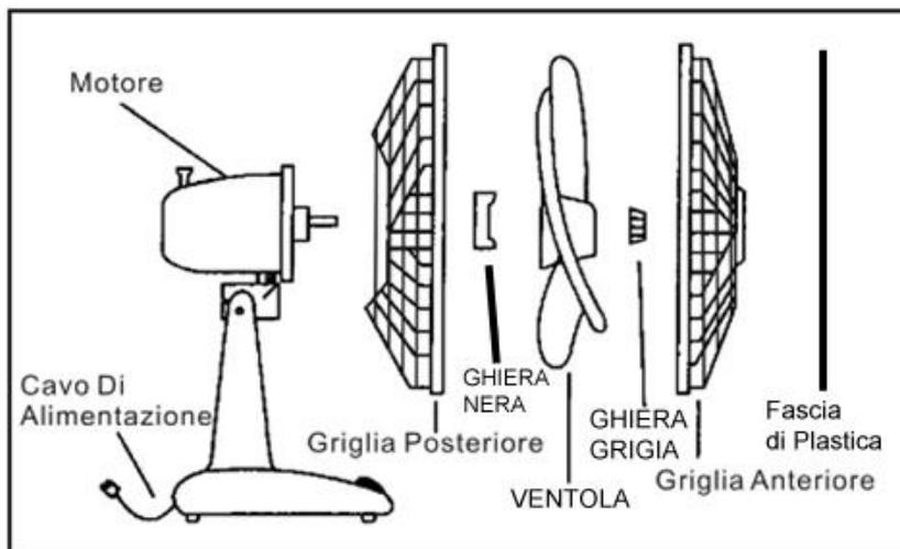
Incastrare il corpo del ventilatore alla base e fissare avvitando le due viti in dotazione nei fori posti sotto la base.
