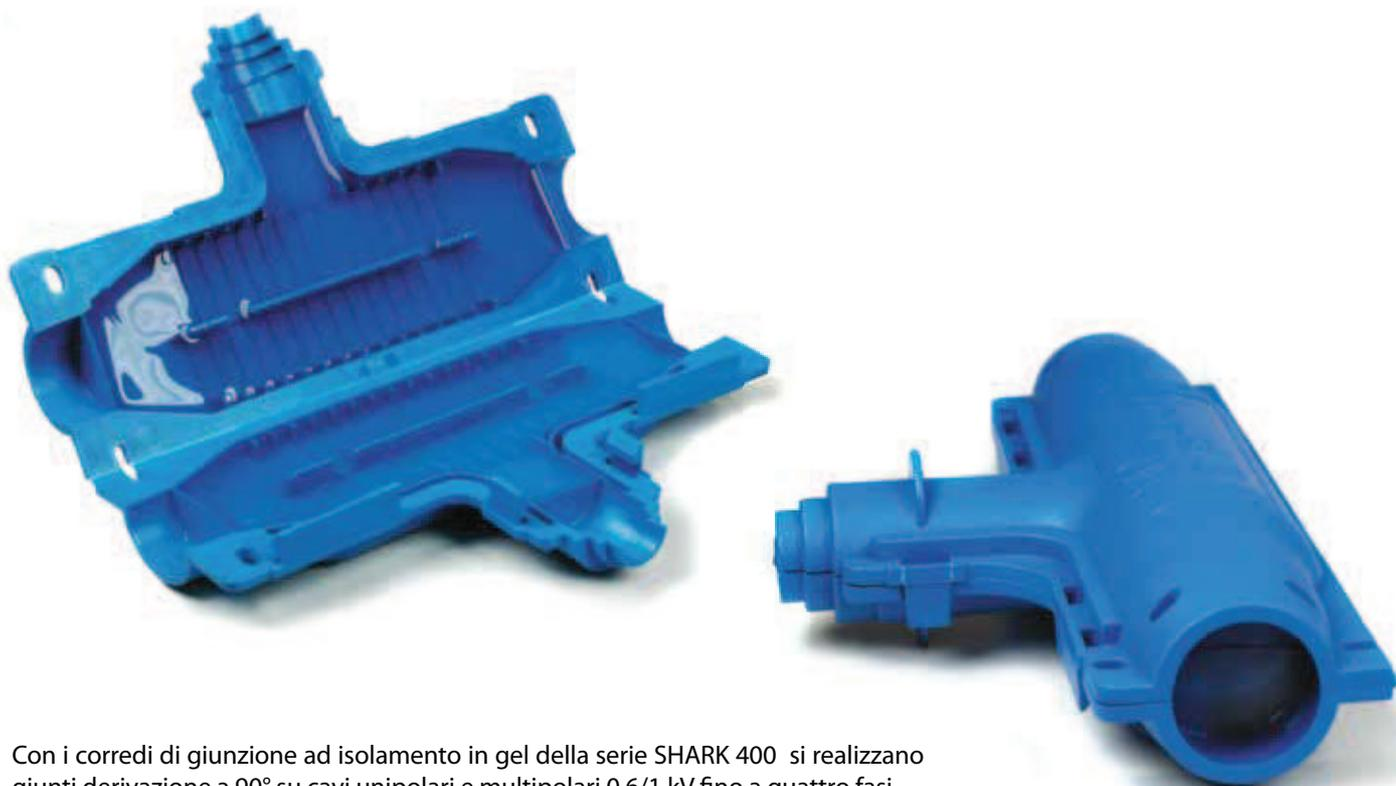
Con i corredi di giunzione ad isolamento in gel della serie SHARK 400 si realizzano giunti derivazione a 90° su cavi unipolari e multipolari 0,6/1 kV fino a quattro fasi. Un sistema brevettato di separatori, garantisce il blocco del cavo all'interno del giunto e consente il montaggio e l'isolamento fino a quattro connettori non isolati montati non sfalsati centralmente nel giunto.
